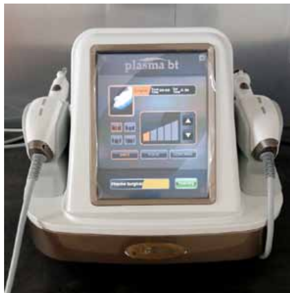
Rycina 1. Urządzenie Plasma BT. Po lewej stronie widoczna jest chirurgiczna głowica, a po prawej głowica shower. Źródło: materiały własne
